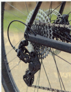
Die Kassette ist auf der ersten Hälfte fein abgestuft, dann folgen die großen Gangsprünge
