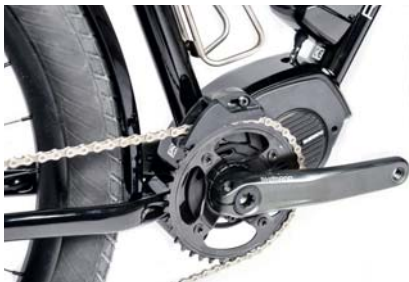
Shimano E-8000 Steps Mittelmotor mit 38er Kettenblatt und Führungsschiene.
