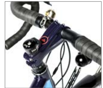
Das Cockpit mit USB-Ladebuchse, Titan-Klingel und Top-Licht.
